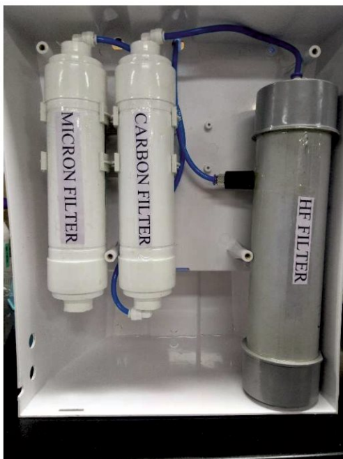
चित्र: हॉलो फाइबर मेम्ब्रेन पर आधारित घरेलू फिल्टर
